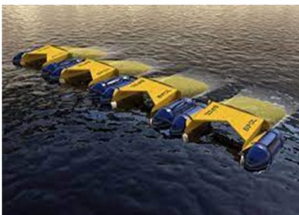
Figure 31 : Dispositif D-POL (captation des déchets flottants) et bateau nettoyeur par Ekkopol et Mare Corsica
