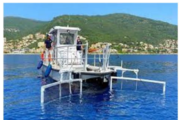
Figure 31 : Dispositif D-POL (captation des déchets flottants) et bateau nettoyeur par Ekkopol et Mare Corsica
