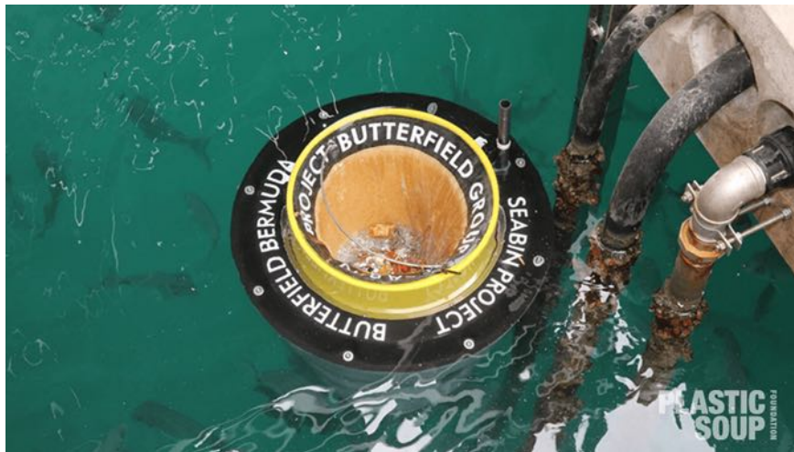
Figure 32 : SeaBin, récupérateur de petits déchets et microdéchets (>2 mm)
